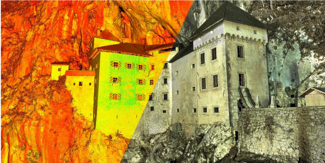
Slika 1: Fotorealističen oblak točk Predjamskega gradu (desno) in oblak točk obarvan z vrednostjo intenzitete odboja laserskega žarka (levo).
